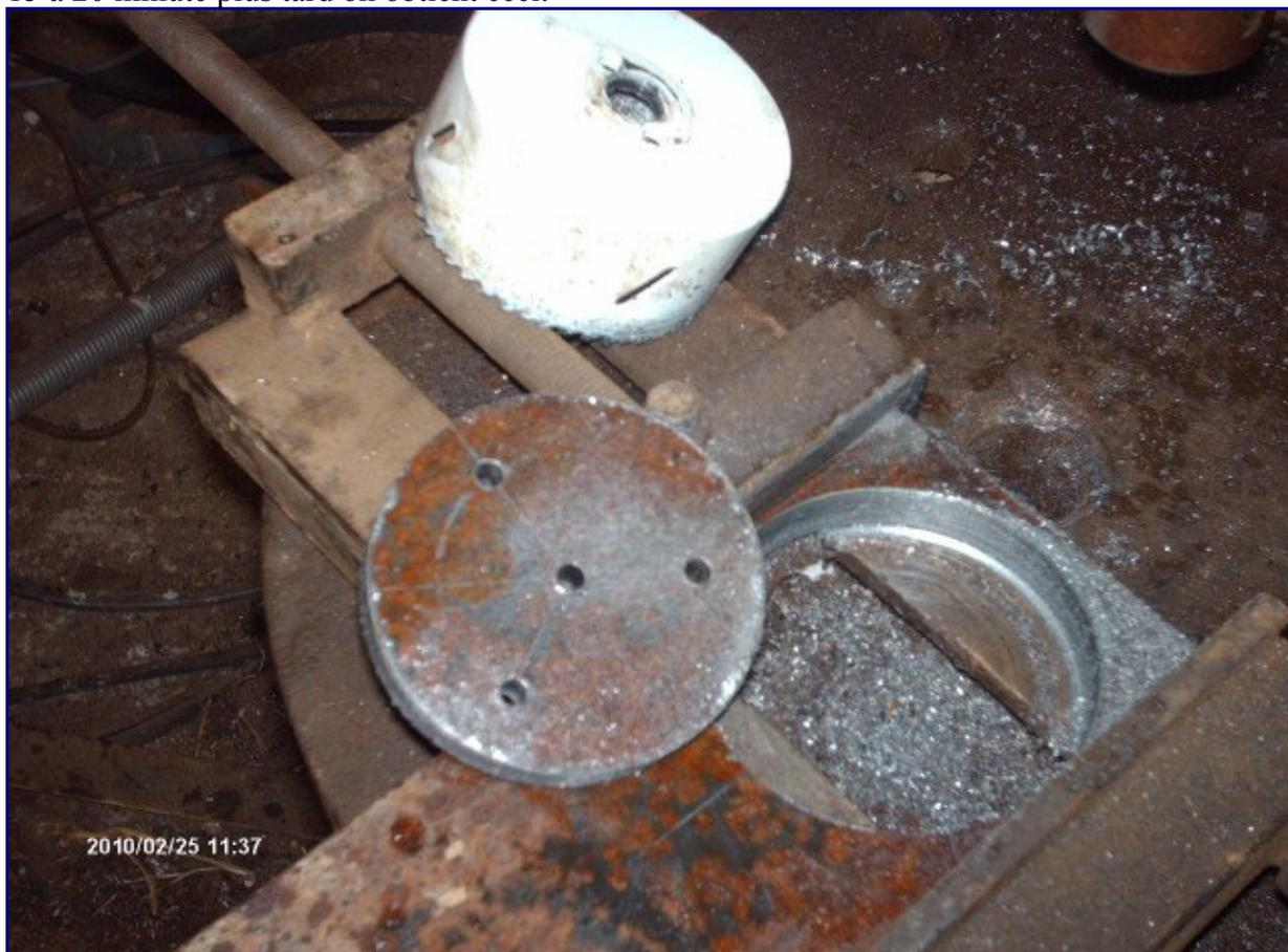
Ensuite vu qu'au centre on met une vis M12 avec un filetage de 1,75 on perce nos 4 trou a 10,3mm, les tiges filetées sont en diamètre 8mm mais il est bon d'avoir un peu de jeu .
