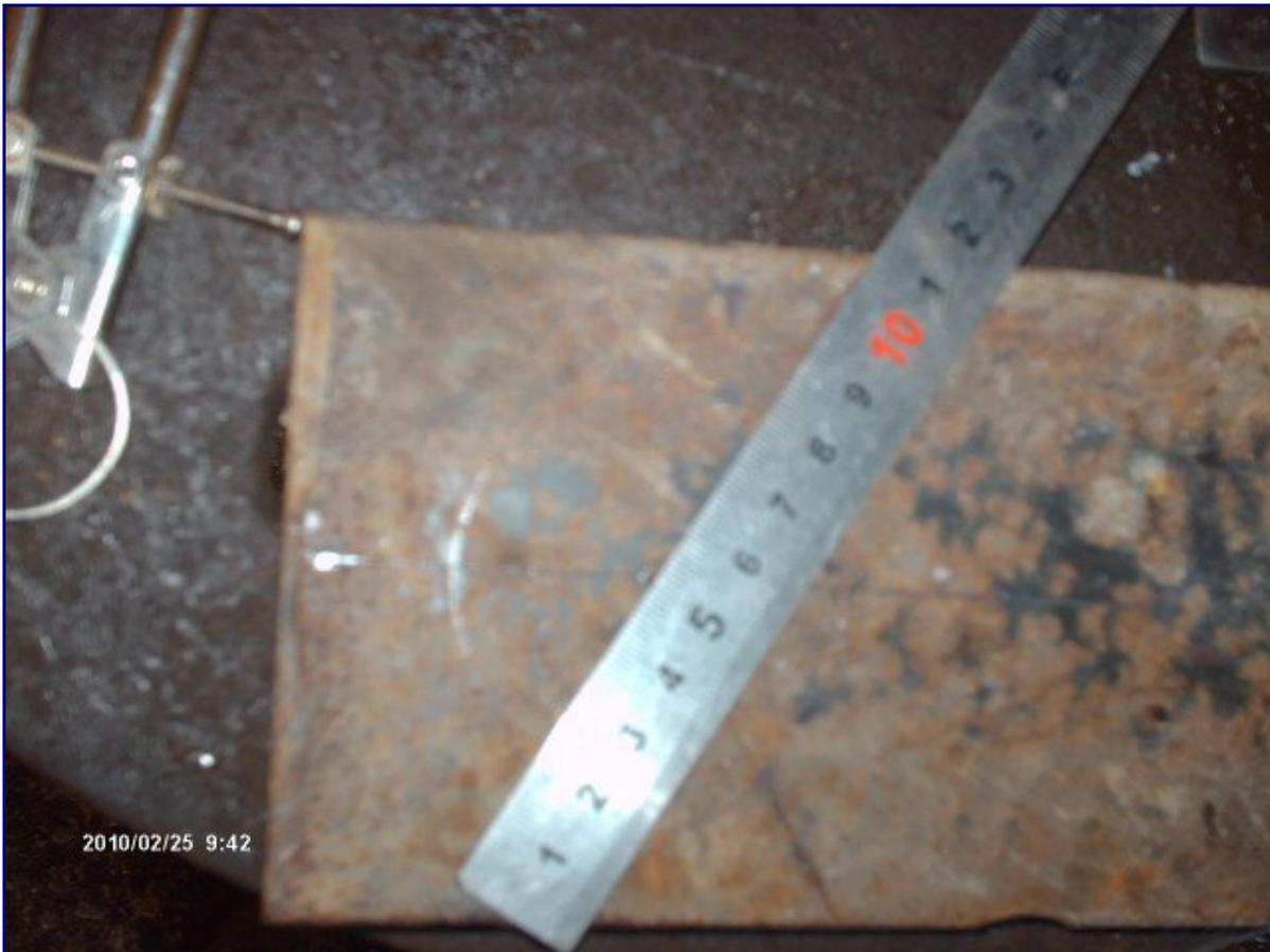
Ensuite on vérifie la cote entre les 3 points, elle doit être de 50 à 51mm, puis on donne un coup de pointeau avant de percer.
