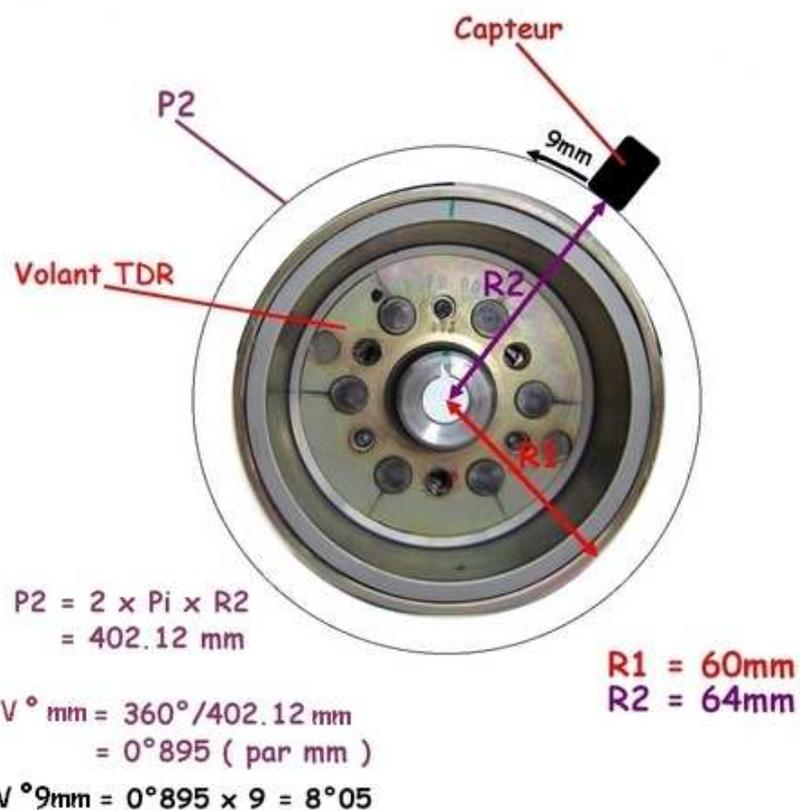
Pour pouvoir modifier la position du capteur il suffit de démonter le carter d'allumage pour avoir accès à celui ci.
