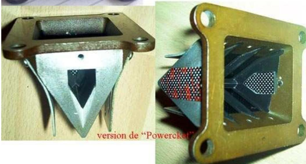
L'idéal serait d'enduire la surface de contact des nouveaux clapets avec un enduit type plastifié pour l'étanchéité, mais encore faut il trouver le bon produit !!!
