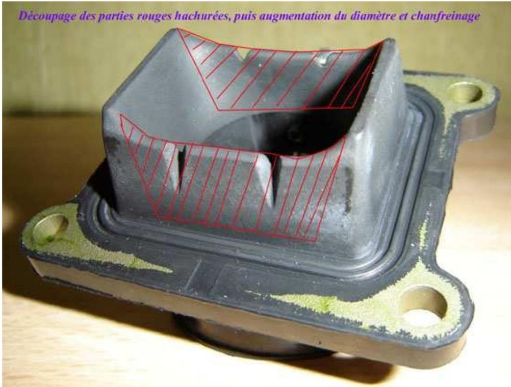
➡ Il faut donc découper les parties hachurées puis augmenter le diamètre interne de la pipe (râpe à bois et papier de verre), pour obtenir une forme se rapprochant le plus possible d'une pipe d'YZ:
