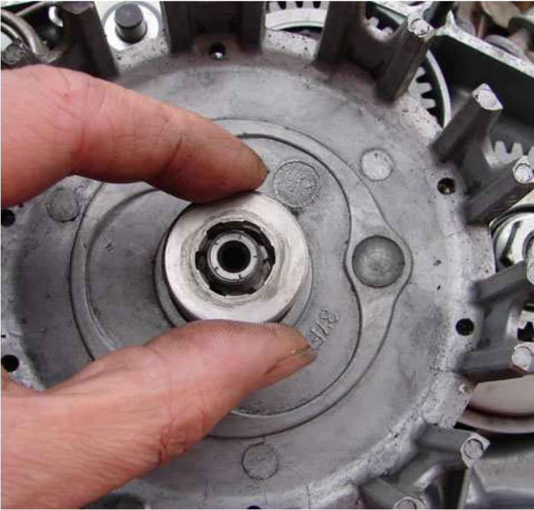
➡ Pour pouvoir serrer la noix j'utilise un bloque noix maison constitué d'un disque lisse et d'un disque garni d'embrayage rivetés entre eux.
