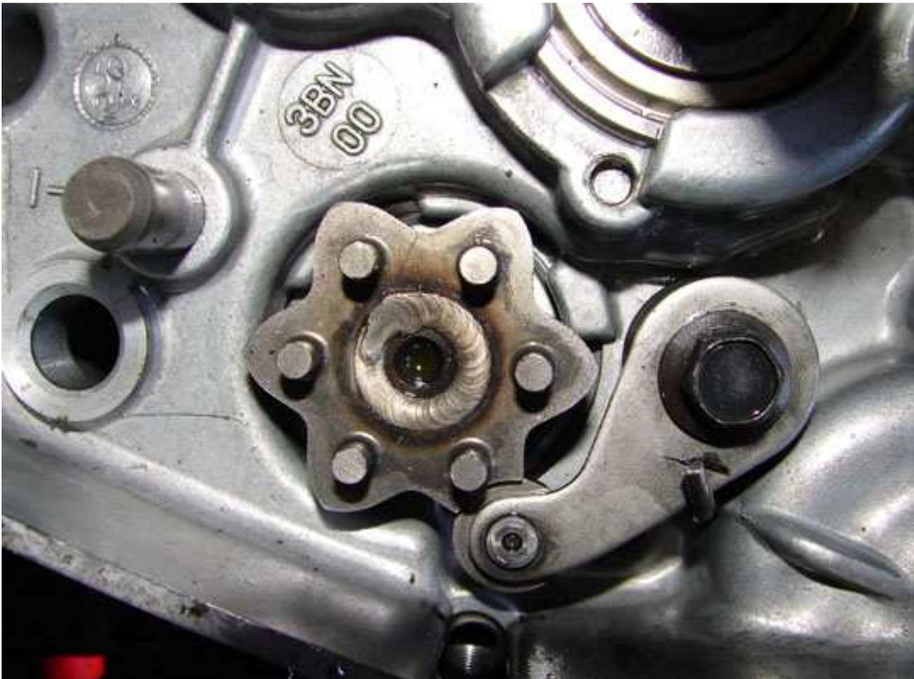
➡ Il faut alors tester si les vitesses passent bien en se servant d'une pince pour actionner le barillet, tout en tournant à la main un des axes de la boîte de vitesse (je le fais avec celui du pignon de sortie de boîte).
