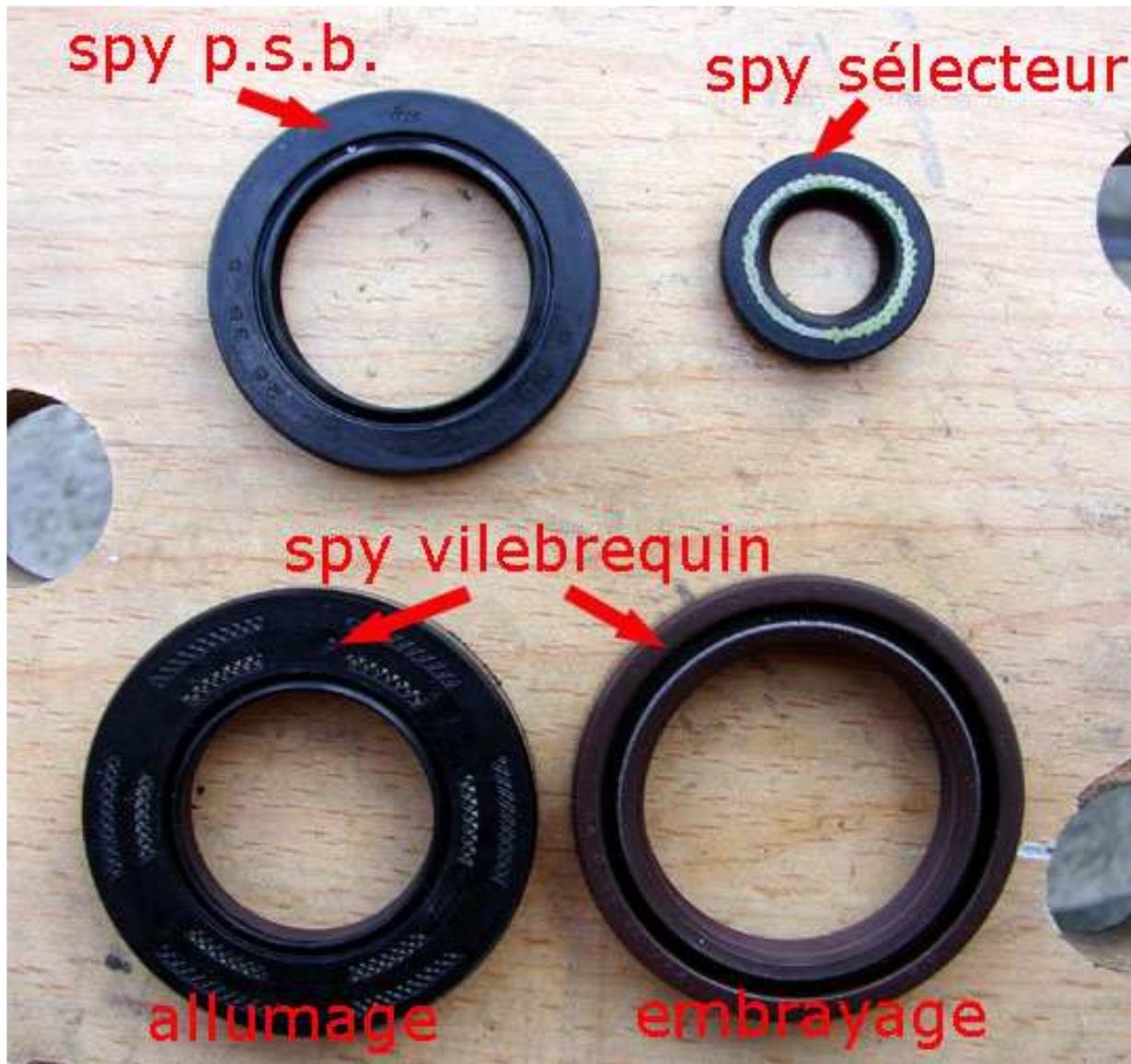
➡ Les joints spy se montent à la graisse, et il faut les enfoncer "à fleur" dans leur logement. Dans le cas du spy coté embrayage, il y a un marquage "outside" que l'on doit voir lors du montage (il n'est donc pas mis coté vilo). Il faut aussi nettoyer les entretoises, et les monter en sans inverse si elles sont trop marquées par l'ancien spy.
