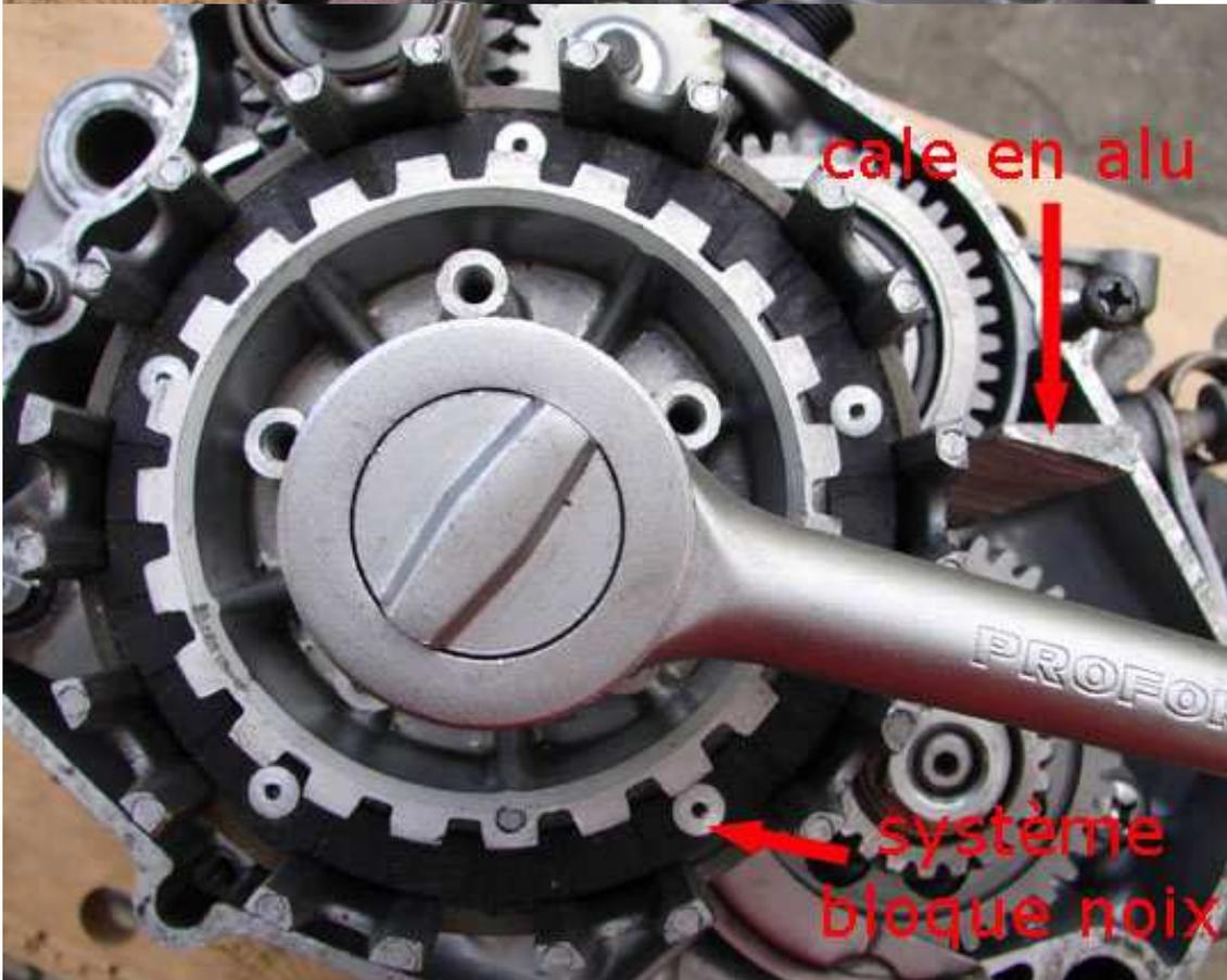
➡ C'est alors au tour des disques d'embrayage d'être mis en place.
