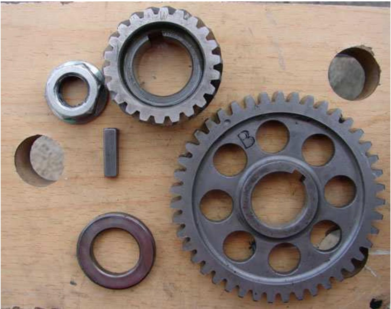
On positionne d'abord la clavette sur le vilo, puis on enfle les pignons en faisant en sorte que le repère soit bien en face de celui gravé sur le pignon du balancier d'équilibrage.
