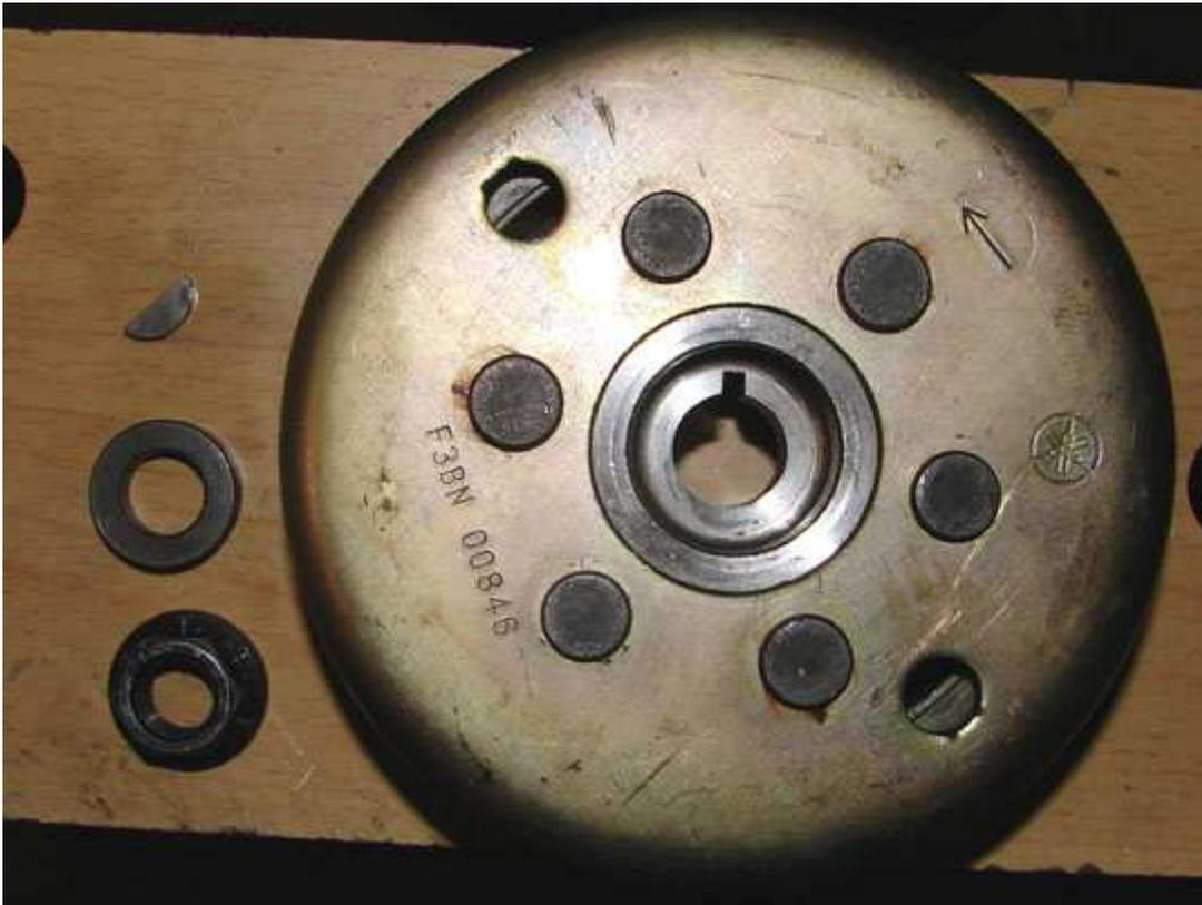
Le vissage se l'écrou se fait à l'aide d'un bloque rotor "maison" et d'une simple clé à pipe de 17.
