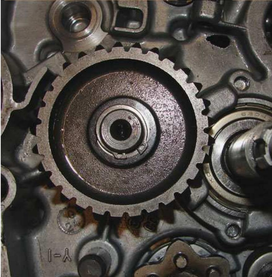
Le mécanisme de kick se monte très simplement, il suffit juste de respecter l'emplacement des ressorts dans le carter.
