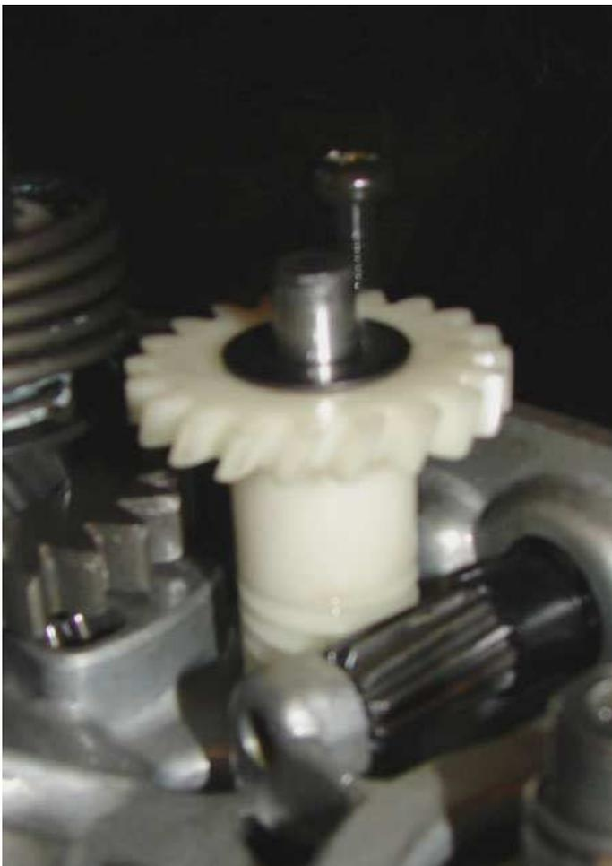
➡ Pour serrer l'écrou du pignon de balancier, j'utilise une cale triangulaire d'aluminium placée entre le carter et le pignon.
