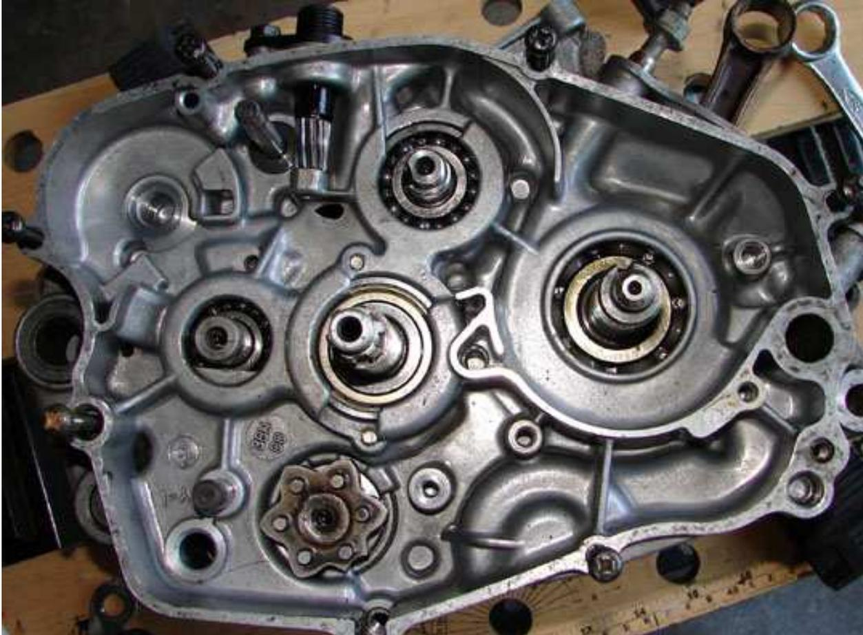
Mais le roulement n'est pas forcément au fond de son logement, et de ce fait les carters ne sont pas jointifs. Il ne faut surtout pas taper pour finir l'assemblage !!
