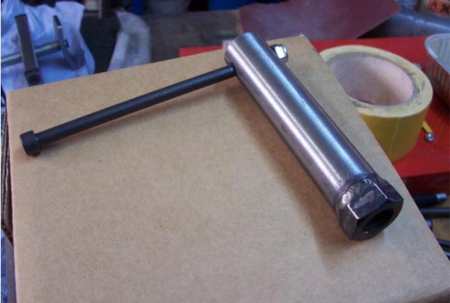
Et on se retrouve ici, j'y rajoute un second écrou, le contre écrou sert à bloquer la poignée.
