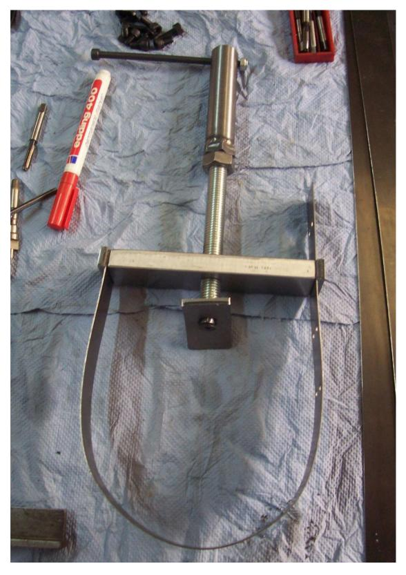
J'allais oublier, pour la finition il faudra mettre une bande de caoutchouc, ou une vieille courroie plate à coller sur le cerclage, et la platine arrondie. Ainsi qu'un coup de peinture bien sur !!
