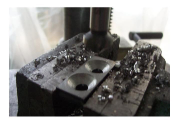
Sur la tige filetée on perce aussi un trou de 5 mm (pour vis M6) Bon faut bien choper le centre, je l'ai fait sur un tour, mais on peut se débrouiller avec la perceuse.
