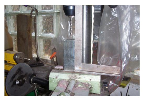
On mesure, on trace, un coup de pointeau et on perce à 5 mm, ben oui c'est pour des vis de M6 je vais mettre 2 vis par cotés.
