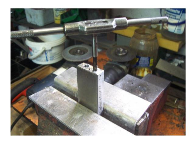
Après je trace le milieu pour le trou de 12 (pour M14) Perçage, chanfreinage, taraudage M14 et voila.
