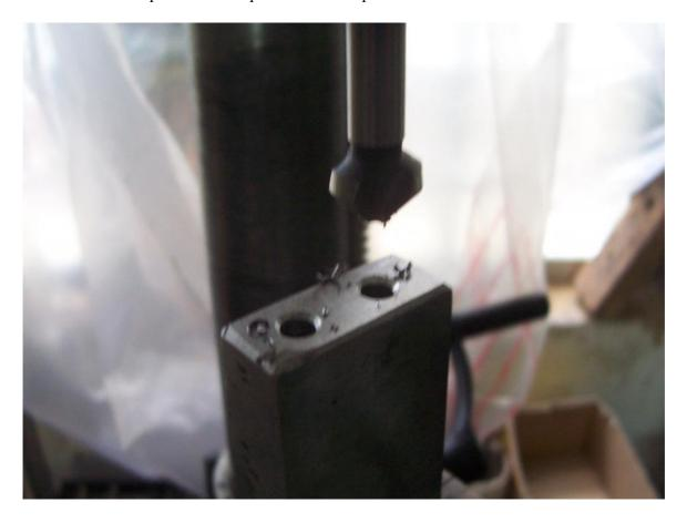
Puis on taraude, j'ai percé des trous de 20 mm de profondeur, j'ai des vis de M6 par 15 qui traînent!
