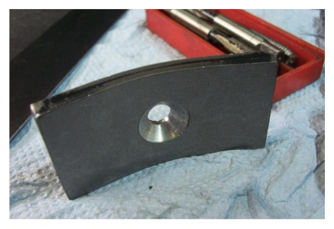
Pourquoi un trou de 10 pour une vis de 6 ? Parce qu'il faut mettre une entretoise sous la vis, pour que la platine ne tourne pas avec la tige filetée.
