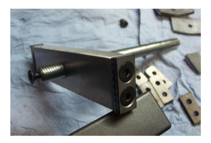
La suite, une platine de 60 x 30 x 5.00 mm, un trou de 10 mm au milieu et chanfrein pour noyer la vis, il faut l'arrondir un peu.
