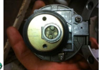
Pour la fin j'ai du mettre la clef dans la serrure et la tourner en position unlock, à droite quoi. Position fermé ça rentrait pas. Enfin ... ça rentrait mais le mécanisme ne fonctionnait pas. Replacer le ressort et faire en sorte que le deux piquots s'emboitent dedans
