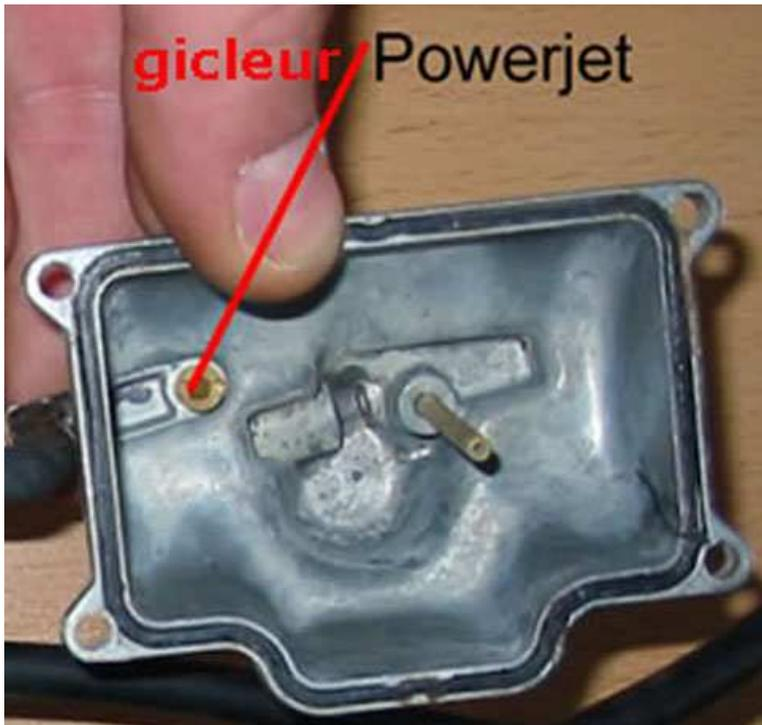
L'astuce consiste à faire sauter notre gicleur intégré d'un coup de perceuse avec un foret de 3mm !!
