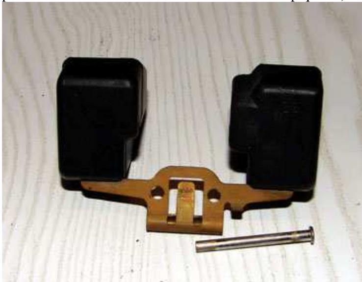
On voit donc maintenant le pointeau qui est libéré, le siège du pointeau étant encore retenu par une vis (parfois très dure à retirer):
