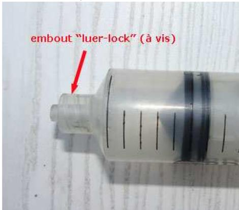
L'avantage de la seringue luer-lock est qu'une fois l'aiguille vissée, elle ne bougera pas lors des tentatives de débouchage d'un des conduits !!
