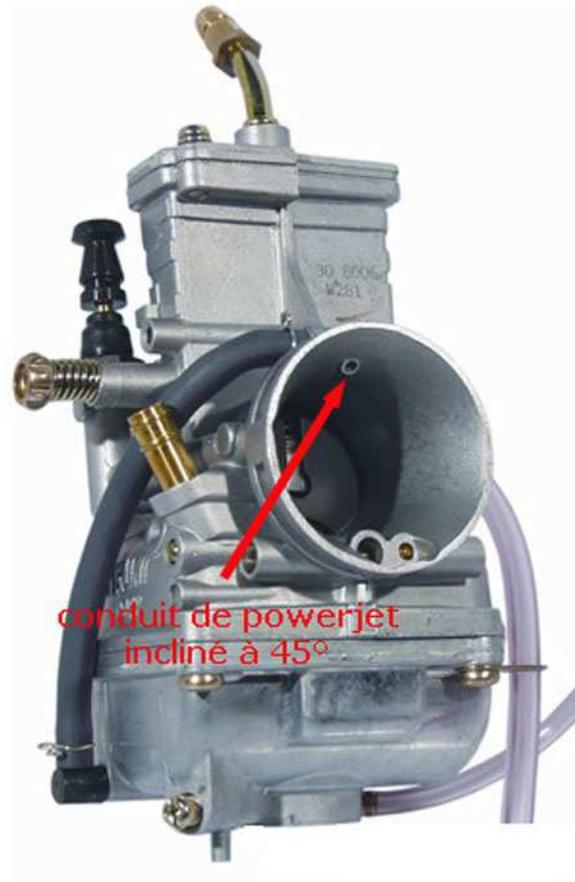
Sur se TM32ss la sortie similaire à la notre est bouchée par une bille, et un trou de même diamètre est présent mais perpendiculairement au flux d'air:
