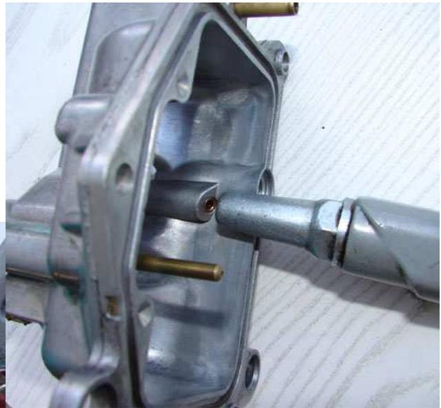
Pour les autres, le mieux est d'utiliser des seringues et des aiguilles, et de commencer avec de l'eau frémissante (presque bouillante) suivi d'un rinçage avec de l'essence.
