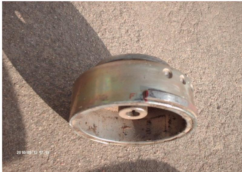
Ce repère doit apparaître au centre du hublot lorsque l'avance est de 17°, et est visible bien sur à la lampe stroboscopique.
