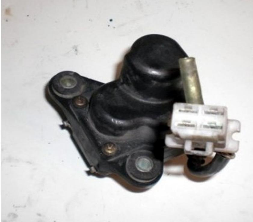
Ce servomoteur est d'origine sur les DTR à partir de 1999, sur les TDR 5AE, sur les DTX/RE, ...ce qui fait que l'installation de l'ignitech sera plus simple pour ces modèles !!
