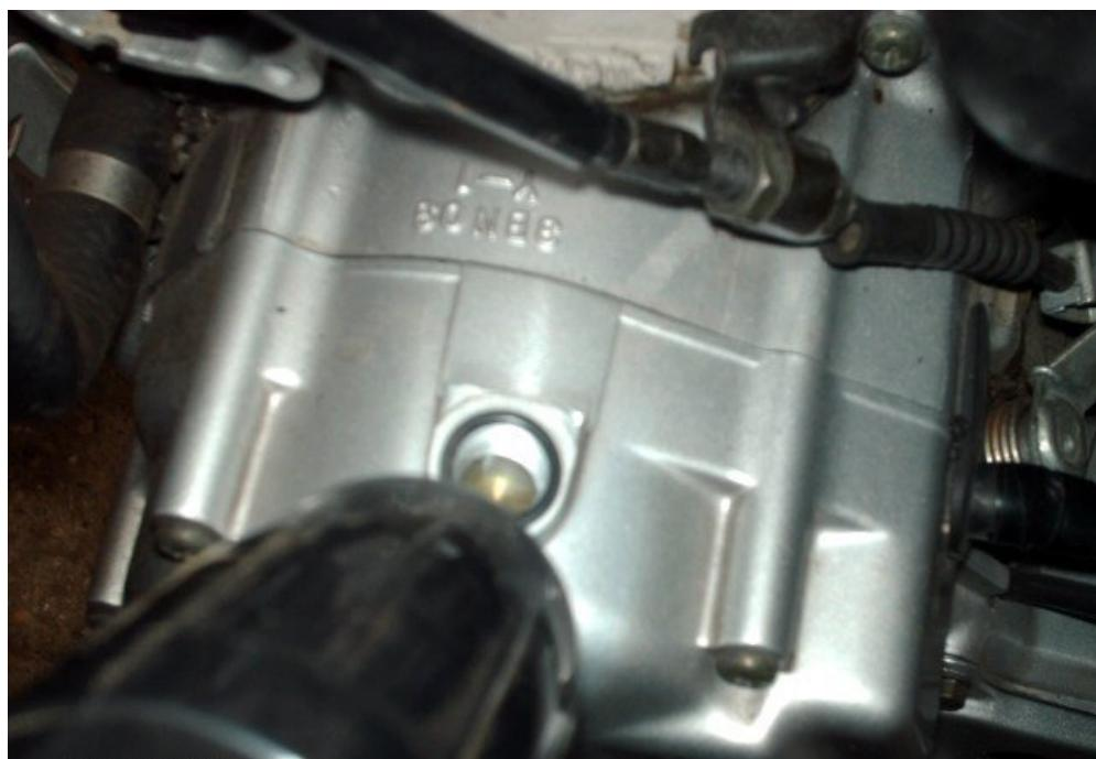
Grâce à la courbe entrée dans le CDI, en faisant varier le régime moteur du ralenti jusqu'à 8500 tours, le repère doit toujours être visible.
