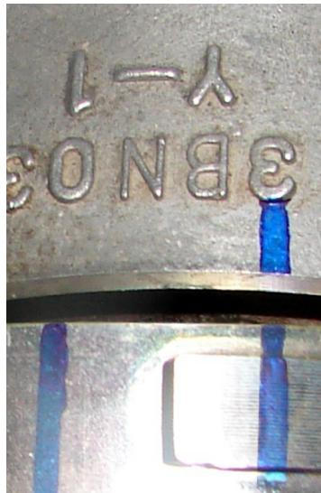
😊 Pour déterminer le repère à 17° du PMH, on utilise soit le disque gradué, ou soit cette règle arithmétique:
