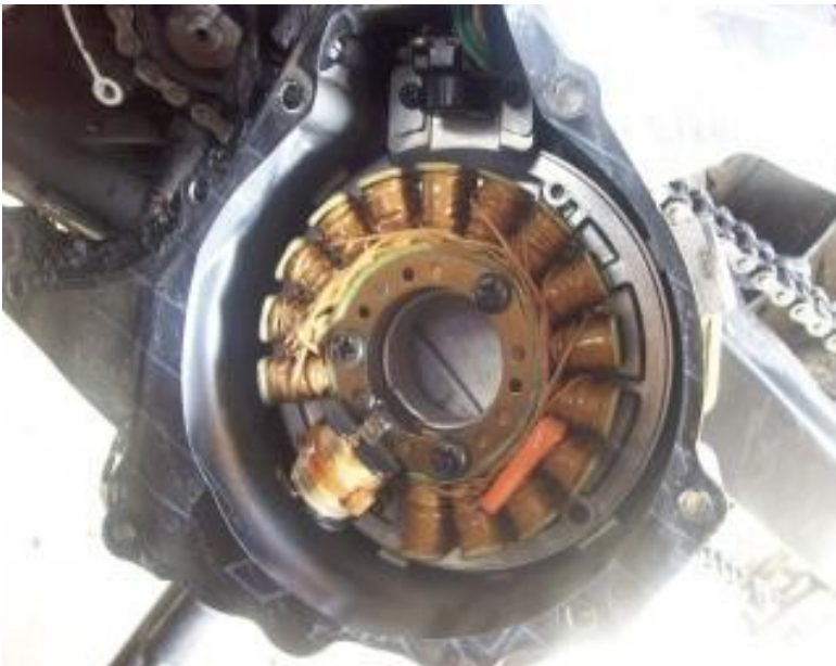
le stator avec la partir qui nous intéresse en haut => le capteur.
