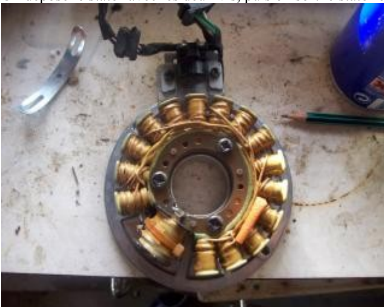
le stator avec la partir qui nous intéresse en haut => le capteur.
