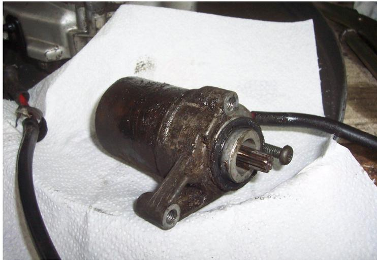
Les vis maintenant sont capot de fixations sont assez dures à retirer, car leur tête est assez petite, et leur taille est de 5,5mm ce qui est très peu répandu, il est donc conseillé de les changer au remontage.
