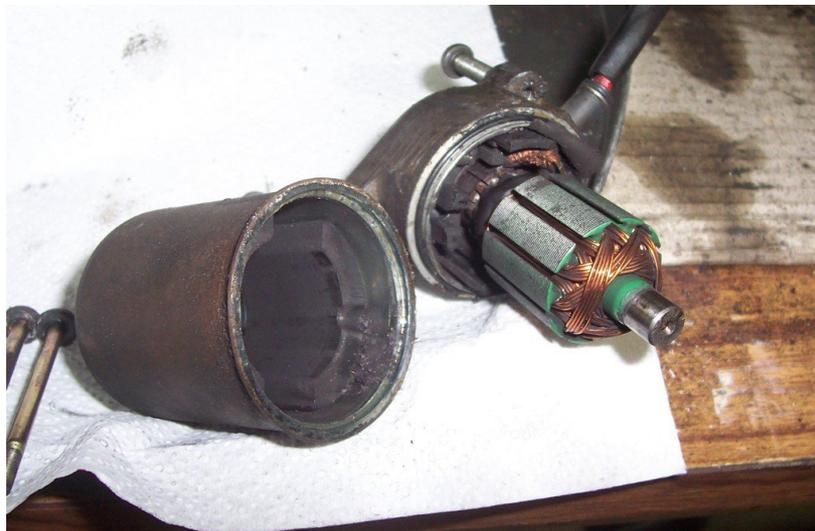
Les aimants contenus dans le capot ont une polarité différente, si ils se retrouvaient inversés au remontage, le démarreur tournerait dans le mauvais sens !!
