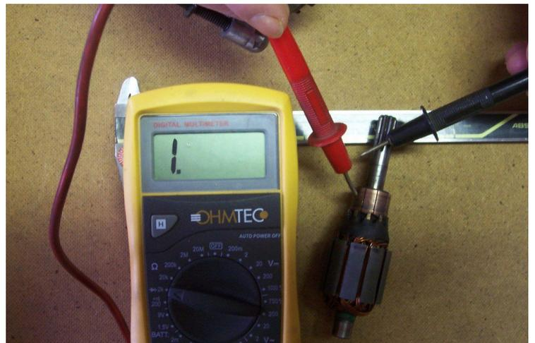
Les interstices entre les lamelles et le mica ont une profondeur devant être comprise entre 0,7 et 1,35mm, c'est à vérifier ainsi qu'à nettoyer, et creuser en cas de besoin.
