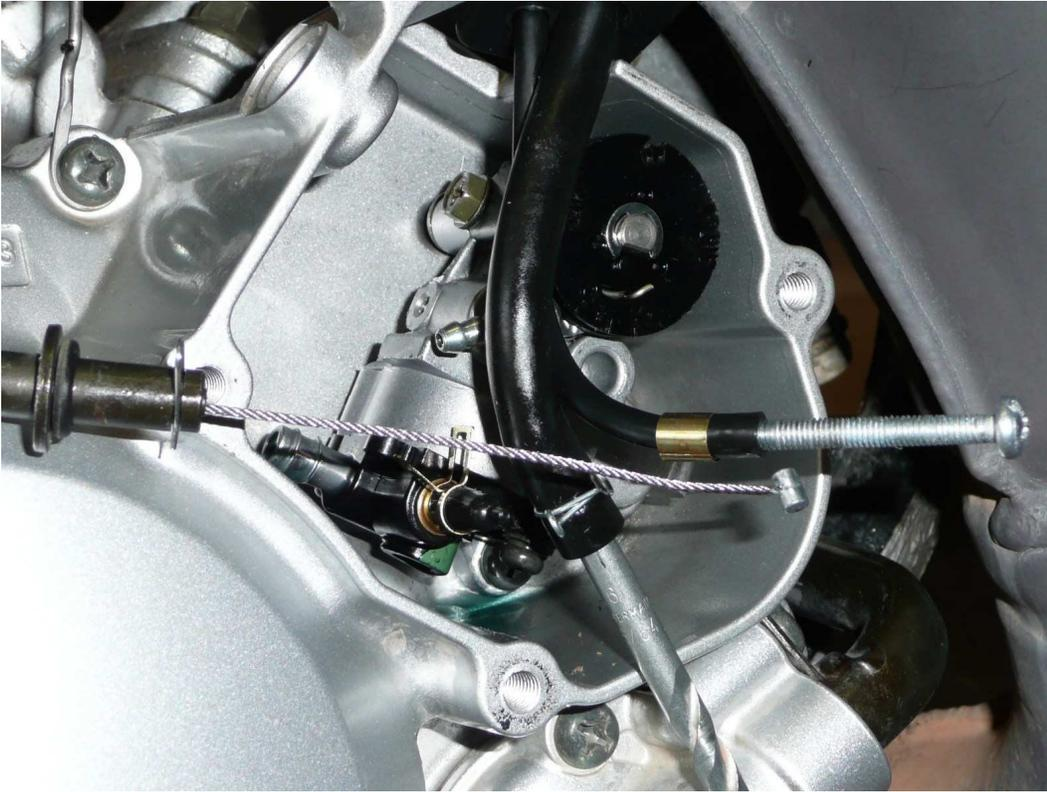
➡ Déposer la canalisation rigide qui vient a la pompe a eau, pour pouvoir la manoeuvrer il faut retirer la vis qui ce trouve a son autre extrémité.
