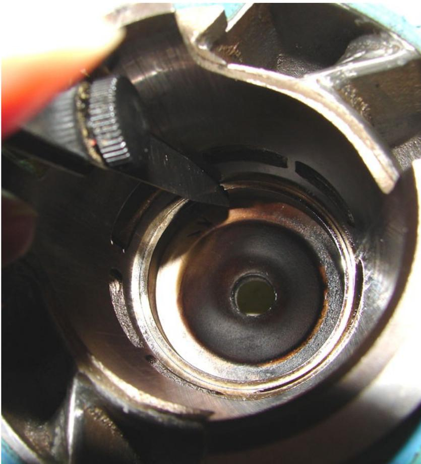
On constate un jeu à la coupe de 0.4mm à l'aide des cales, ce qui est encore dans la norme (0.3 à 0.45 préconisé par Yamaha).
