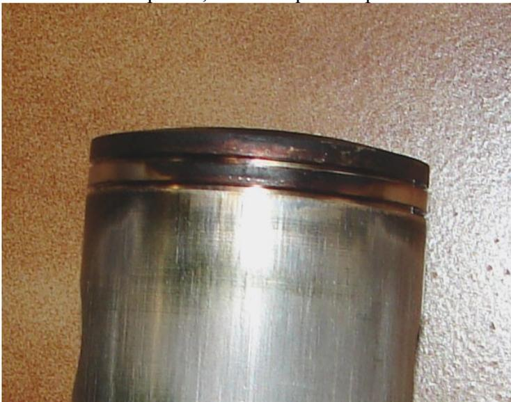
Il y a des traces de combustion au niveau de la lumière d'échappement entre les 2 segments, mais rien sur tout le tour ni sous le second segment.
