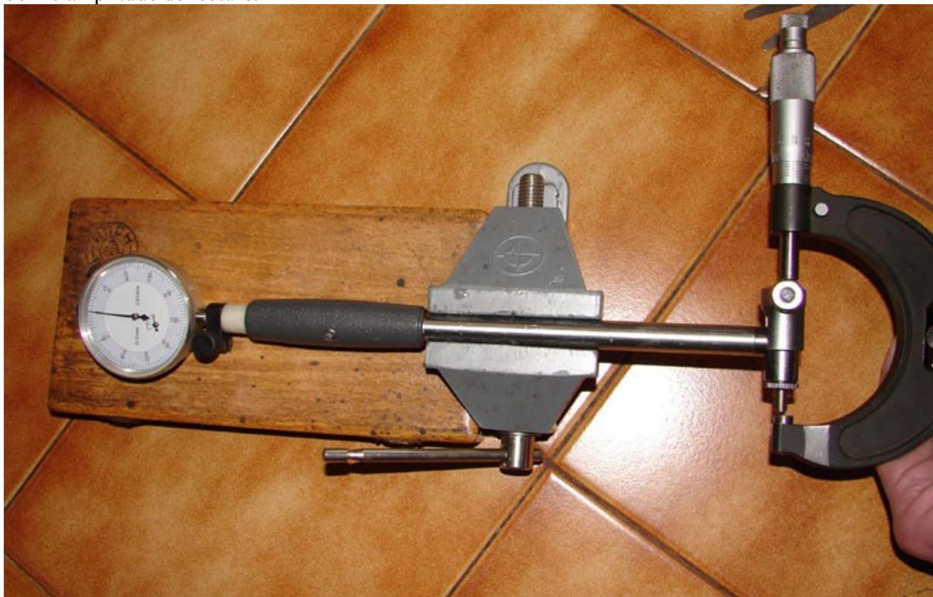
Le calibrage se fait en cherchant le sommet de la variation d'aiguille du comparateur d'alésage pour y caler le zéro du cadran de comparateur.
