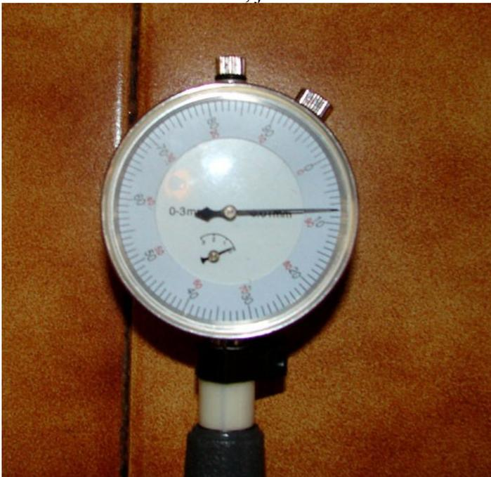
Le comparateur d'alésage était calé sur 56.10mm, ce qui veut dire que la cote exacte du cylindre est de:  $56.10 - 0.09 = 56.01\text{mm}$ .
