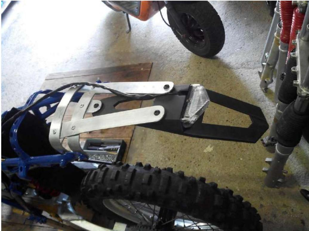
La solution simple avec une selle d'origine reste le GB ar type YZ de chez Motofiled.
