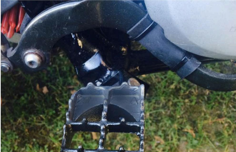
Pour éviter que des branches ne se coincent entre la pédale et le cadre, celle-ci est attachée avec un câble... quand celui-ci ne s'est pas arraché en faisant son devoir...
