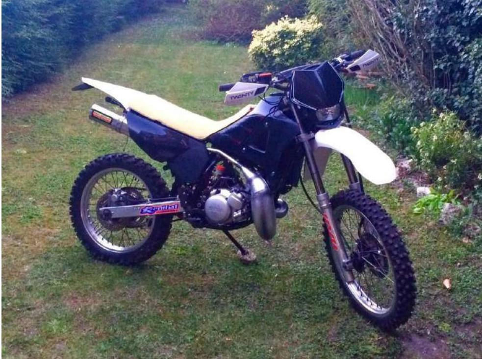
L'avant ayant tendance à prendre des pocs faute de garde au sol, je l'ai équipé, après l'avoir regonflé, d'un protège-pot fibre redécoupé dans les restes de celui d'une 250 KTM.
