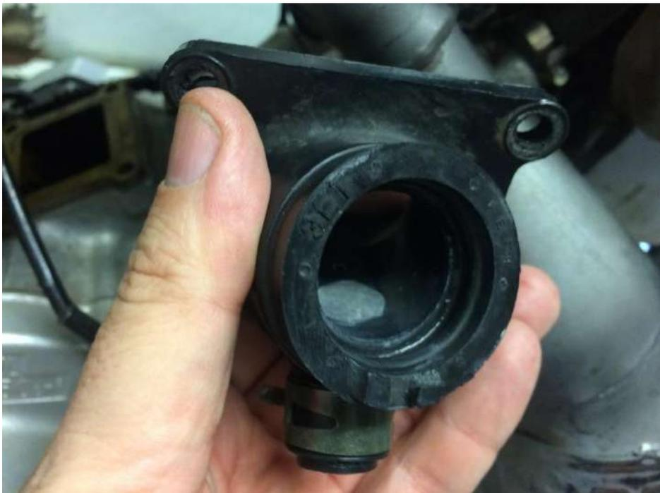
Suppression également du réchauffage du carbu, avec des vis sur la culasse et en ôtant les inserts sur le carbu, comblés à la pâte à joints.
